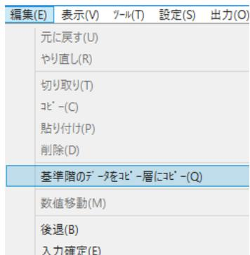
層コピーが行われた後は、実体データとなっているため、パース上などで基準階以外のコピー階の要素データを修正することもできますが、基準階以外の層では平面図に反映はされません。
