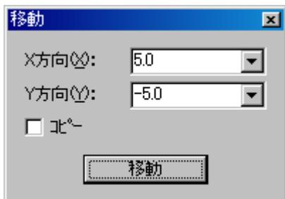
X 方向：X 方向の移動量を設定します。
