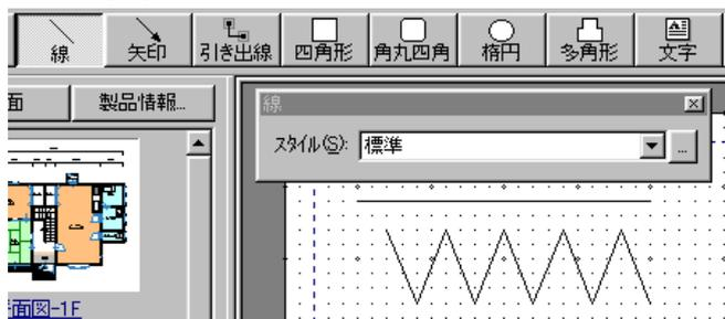
※Shift キーを押すと折れ線が入力できます。矢印、引出し線も同様です。
