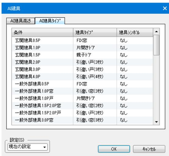
建具の自動判定は、原則として部屋空間の組み合わせから建具の種類を決定する仕組みになっていますが、ここではそのデシジョンテーブルを設定変更します。
