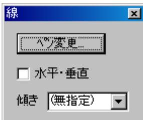
水平・垂直：水平・垂直にチェックを設定し、水平・垂直線を入力することができます。
