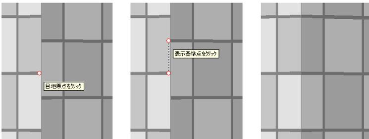
目地原点の選択 ⇒ 表示基準点の選択 ⇒ 目地合わせ実行後
