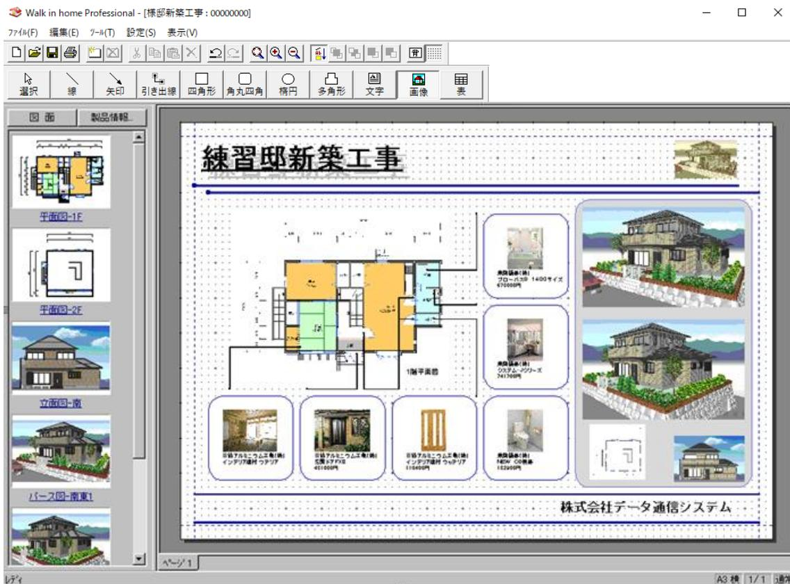
プレゼンボードはシステムで作成した各種画像を配置して印刷する機能です。
